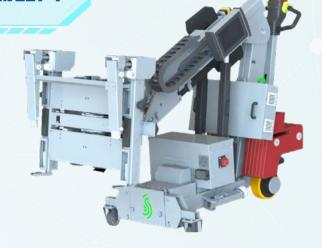
新輝建築創科自主研發「預製板安裝機器人」, 融合多個 領域的創新技術,實現了建築施工中預製混凝土板的智 慧化安裝。
